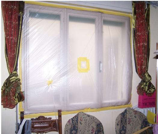
La procedura A-Wert permette di determinare la tenuta di un singolo serramento, verificandone l'effettiva qualità anche con l'edificio in servizio.
