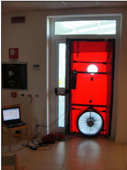
Al termine i dati registrati vengono elaborati in funzione del volume dell'ambiente in cui la prova è stata eseguita.
